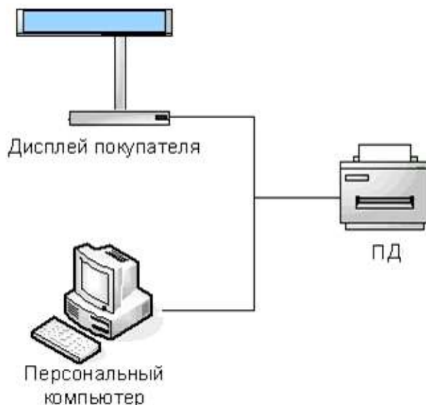
Рисунок 4. Подключение внешних устройств к ПД
